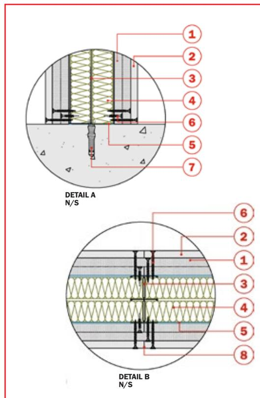
Enfin, recouvrir les joints entre les panneaux et les têtes des vis avec de la **Pâte à joints Tecbor**®.
