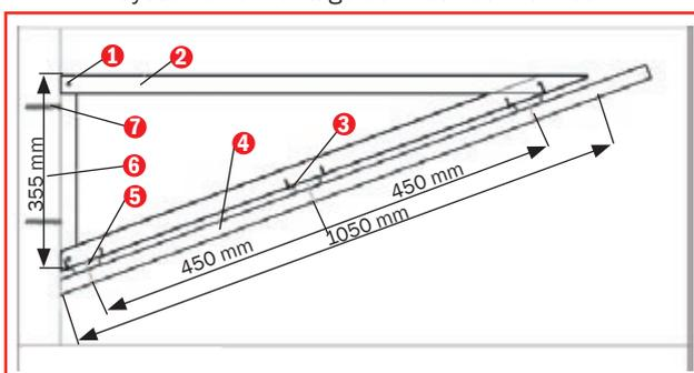
Sur la bande inclinée, la plaque est orientée dans le sens longitudinal. Le côté qui mesure 1 mètre est plaqué contre le mur.
