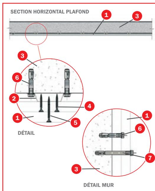
La protection des murs est faite par deux panneaux de **Tecbor**® 20 mm ancrés directement sur le béton. Afin de fixer la première couche, utilisez des ancrages métalliques 8x46 mm. Pour la deuxième couche, utilisez des ancrages métalliques 8x76 mm M6.
