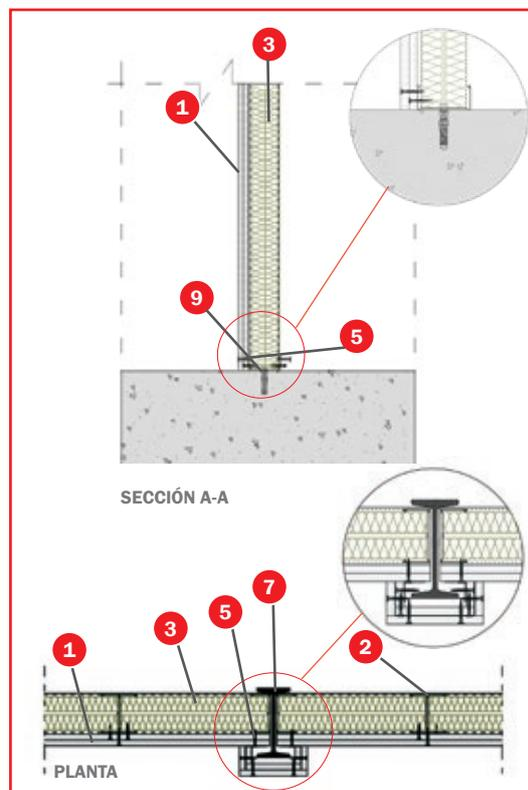
Appliquer la **Pâte à joints Tecbor®** sur les unions entre panneaux et sur les têtes des vis.
